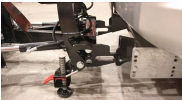
Attache Quick Hitch – système de montage rapide
