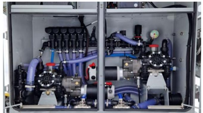
Pompes à membrane auto-amorçantes à haute pression et à haut débit, moteurs et vannes en armoire fermée
